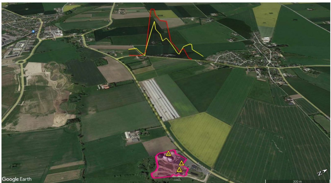
Figur 3. Eksempel på transekt, hvor der måles metan og sporgas nedvinds anlægget. Højden af den røde kurve er proportional med målt koncentration af metan over baggrunds niveau. Højden af den gule kurve er proportional med målt koncentration af sporgas. Gule trekanten markerer placering af sporgasfrigivelse.
