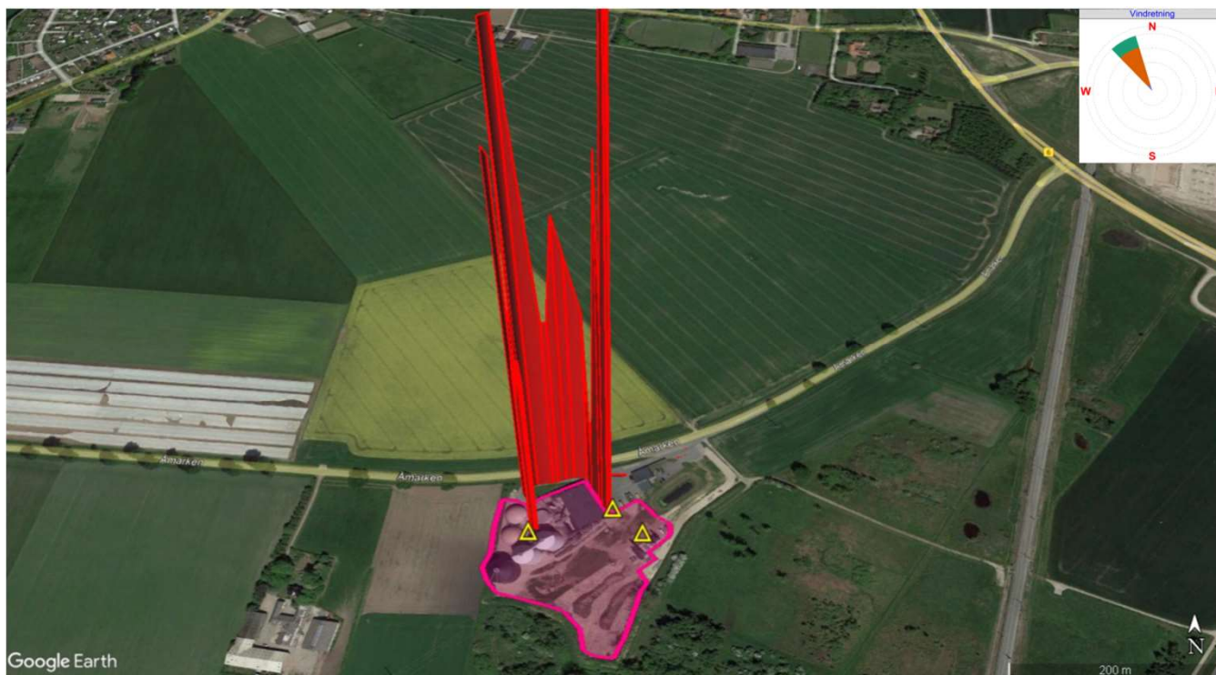
Figur 1. Resultat af screening af metankoncentration på anlæg. Højden af den røde kurve er proportional med målt metankoncentration over baggrunds niveau. Prøvetagning af luft er foretaget i ca. 2m højde.
