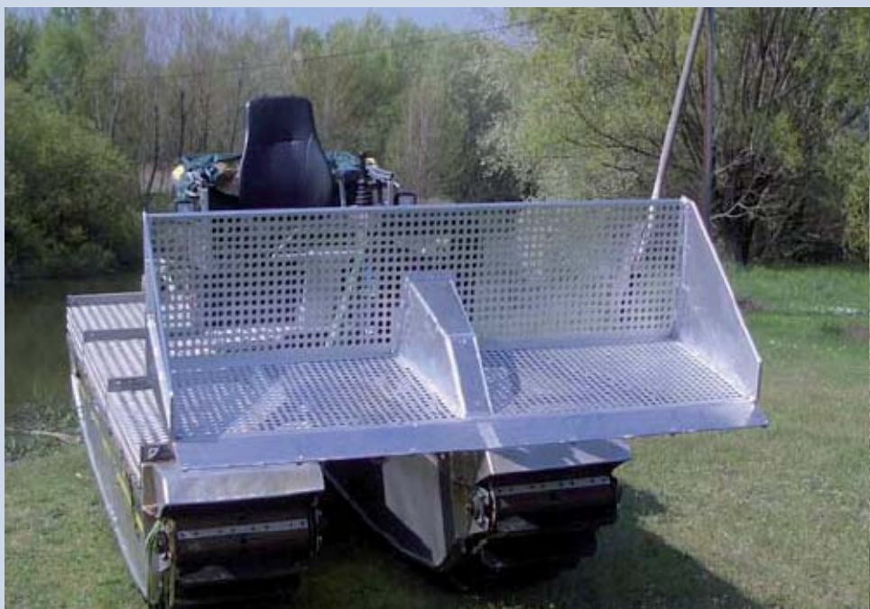
Figur 3. Indsamlingsmaskine til opsamling af tang i vandet (kilde: www.doroteamekaniske.se )
